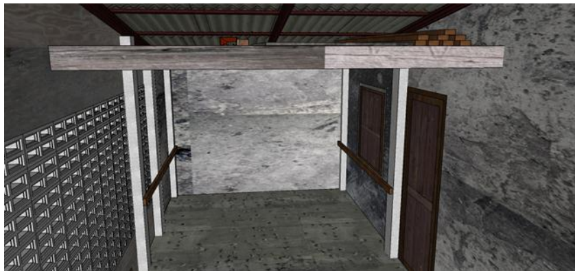
ภาพที่ 5.11 การเก็บส่วนประกอบพื้นสำหรับวางบนจุดรองรับบนเสาคอนกรีตในเวลาที่ไม่ท่วม
