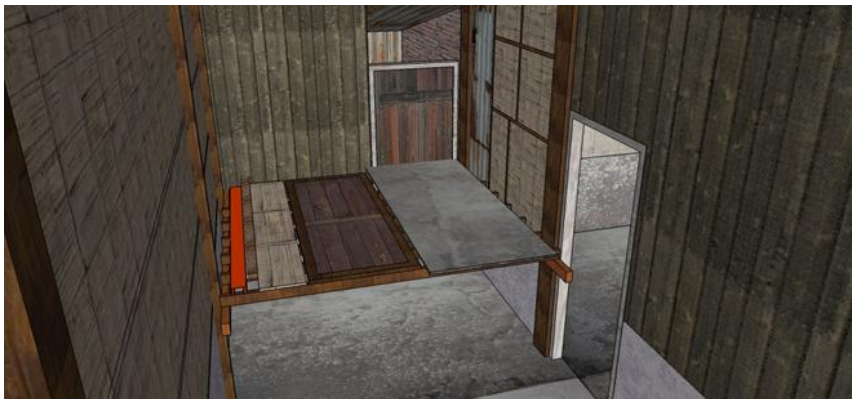
ภาพที่ 5.9 การจัดวางส่วนประกอบพื้นที่วางบนจุดรองรับบนเสาไม้เมื่อน้ำท่วม
