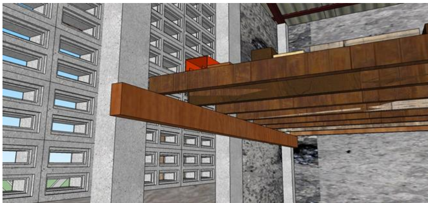
ภาพที่ 5.13 การวางตงพื้นบนคานที่ถ่ายน้ำหนักลงเสาคอนกรีต
