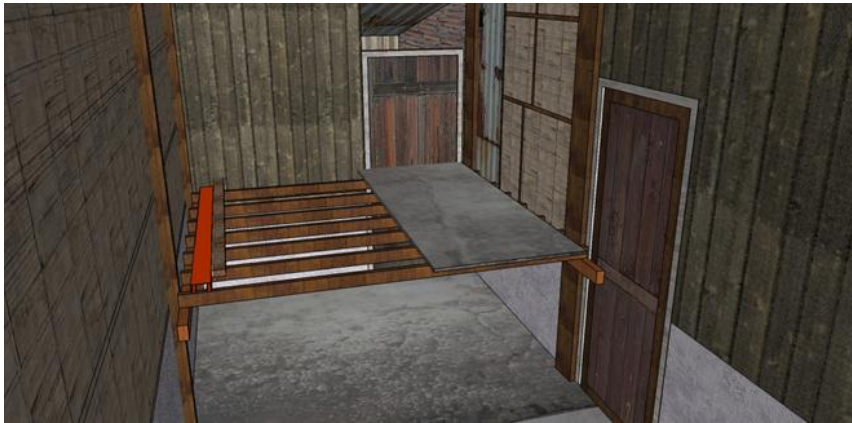
ภาพที่ 5.8 การจัดวางส่วนประกอบพื้นที่เมื่อบางส่วนที่วางบนจุดรองรับบนเสาไม้
