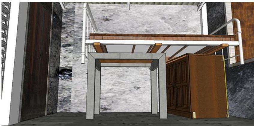
ภาพที่ 5.4 ลักษณะการรองรับของเฟอร์นิเจอร์
