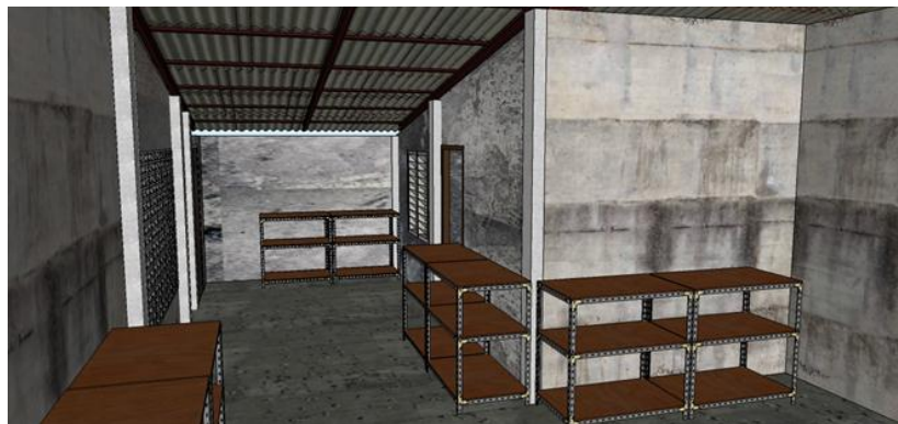
ภาพที่ 5.21 เฟอร์นิเจอร์ลอยตัวสามารถใช้วางของทั่วไปเมื่อน้ำไม่ท่วม
